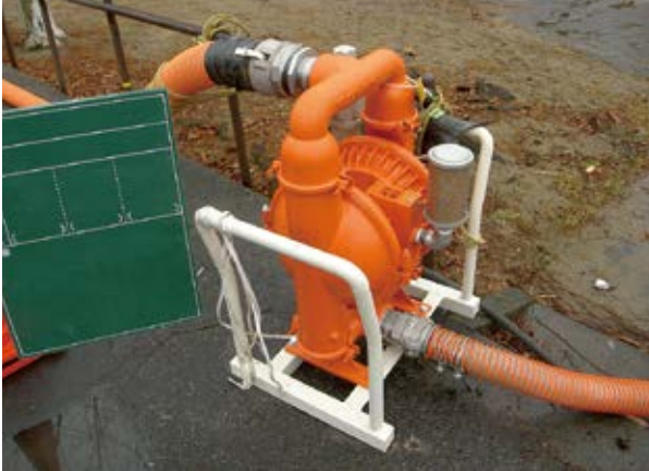
エアハートポンプ外観
