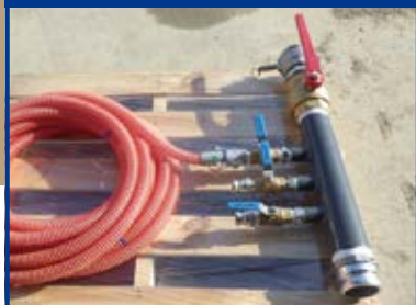
エアハートジャンクション (宅柵集水調整バルブ)
